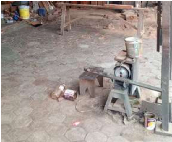
Gambar 1. Kondisi mesin pengasah planar pada UMKM Rizal Mebel dilakukan secara manual
