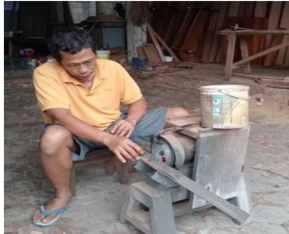
Gambar 1. Kondisi mesin pengasah planar pada UMKM Rizal Mebel dilakukan secara manual
